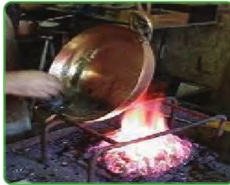
الشكل (٢٧): التخمير «تسخين المعدن لإكسابه اللدونة».
